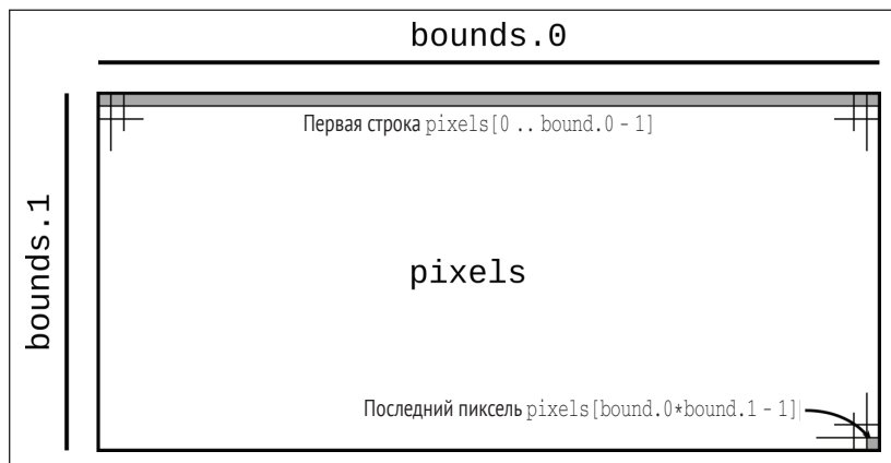
Рис. 2.4 ❖ Использование вектора как прямоугольного массива пикселей
