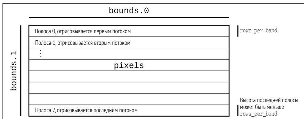
Рис. 2.5 ❖ Разбиение буфера пикселей на полосы для параллельной отрисовки
